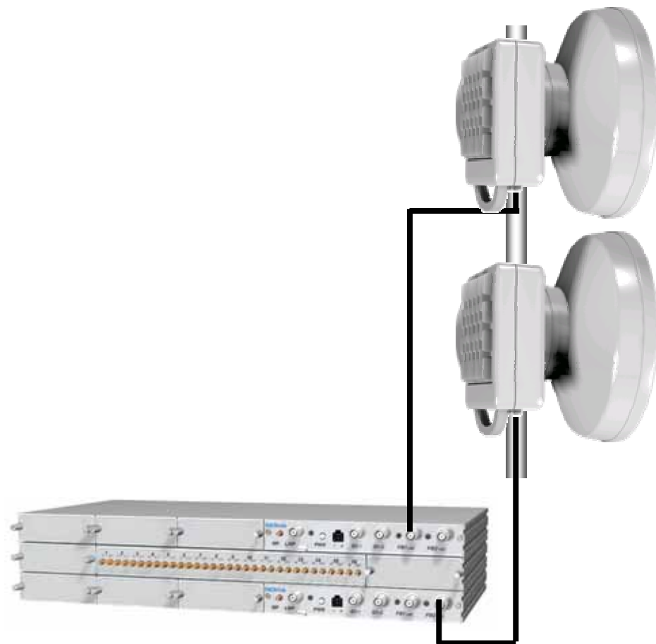
Полное резервирование оборудования
